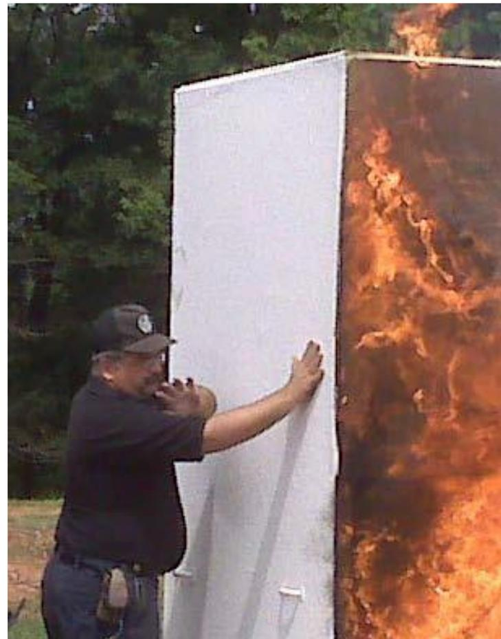
*Structure en OSB dont un panneau recouvert de ThermaCote qui met 15 min à brûler*
